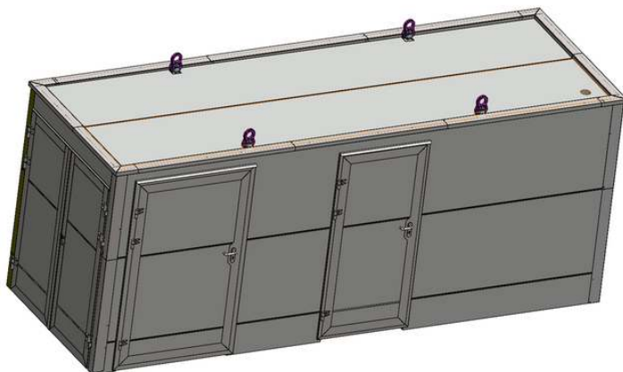
Rys. 8: Instalacja wszystkich punktów mocujących przed transportem
