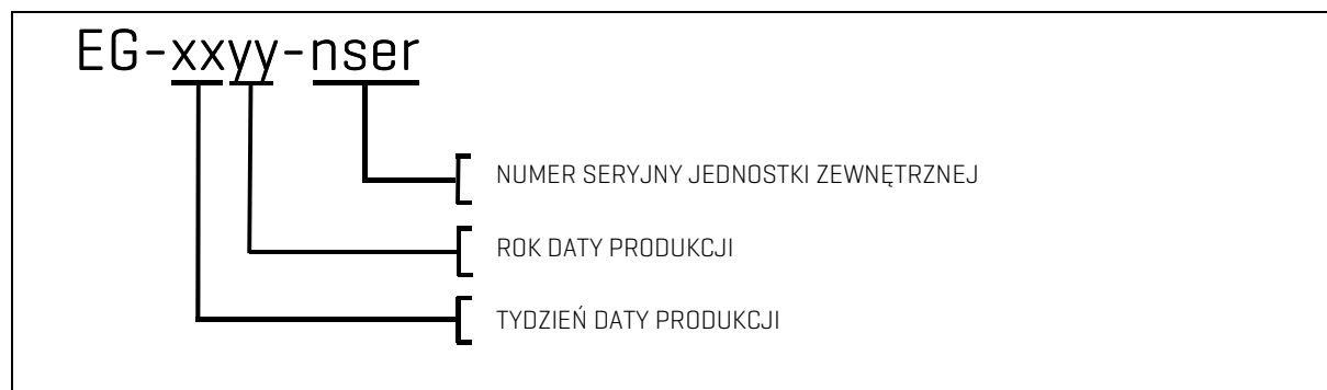
Rys. 2: Kodowanie numeru seryjnego jednostki zewnętrznej.
