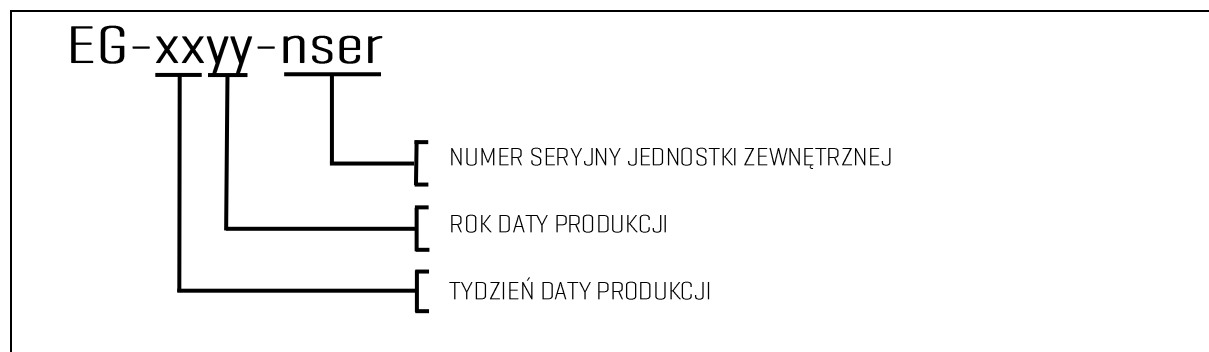
Rys. 2: Kodowanie numeru seryjnego jednostki zewnętrznej.
