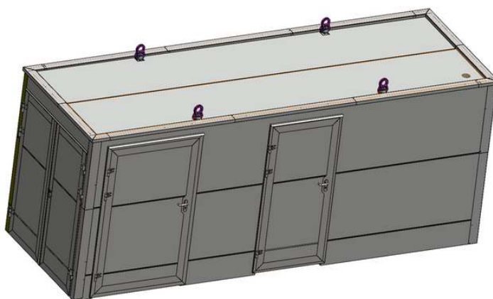
Rys. 7: Wkręcony punkt mocujący do konstrukcji pompy ciepła EUROS CONTIBLOC MICRO
