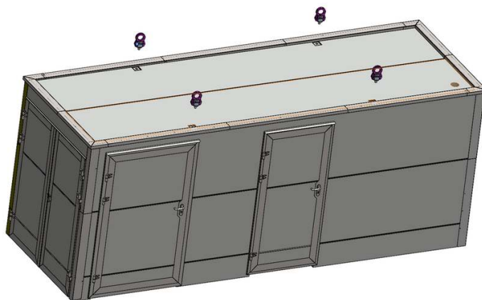
Rys. 5: Rozmieszczenie transportowych punktów mocujących w pompie ciepła EUROS CONTIBLOC MICRO
