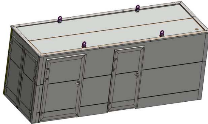
Rys. 8: Instalacja wszystkich punktów mocujących przed transportem
