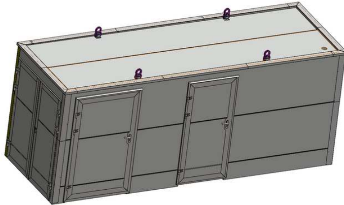
Rys. 8: Instalacja wszystkich punktów mocujących przed transportem.
