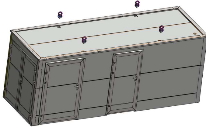
Rys. 5: Rozmieszczenie transportowych punktów mocujących w pompie ciepła EUROS CONTIBLOC MINI.
